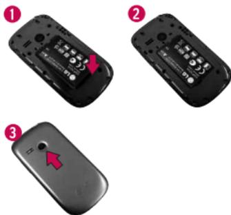
3. Alinee la tapa de la batería y deslícela hacia arriba hasta que encaje en su lugar (vea la imagen 3).
